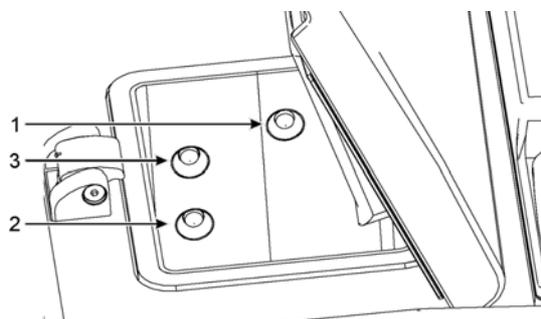
Cada retorta cuenta con tres sensores del nivel de líquido que controlan los niveles de líquido. Los dos sensores inferiores controlan los niveles de dos y tres cestas. El sensor superior se activa si entra en la retorta un nivel de líquido superior al máximo permitido (5,3 litros). Se trata de una función de seguridad.
