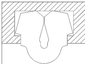
Figura 7.15: Sección transversal de la junta del baño de parafina en la tapa.
