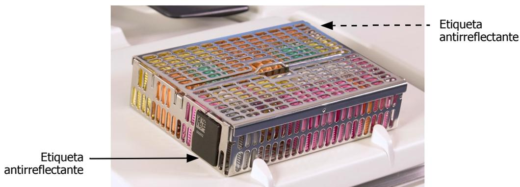
Una de las etiquetas antirreflectantes por cesta viene con un código de barras exclusivo. Este código de barras puede escanearse antes de colocar la cesta en la retorta. El código de identificación se registra con el resto de datos de la ejecución de procesamiento. Después de escanear la etiqueta antirreflectante, podrá colocar la cesta en la retorta en la orientación que desee (es decir, con la etiqueta antirreflectante con el código de barras a la izquierda o a la derecha).
