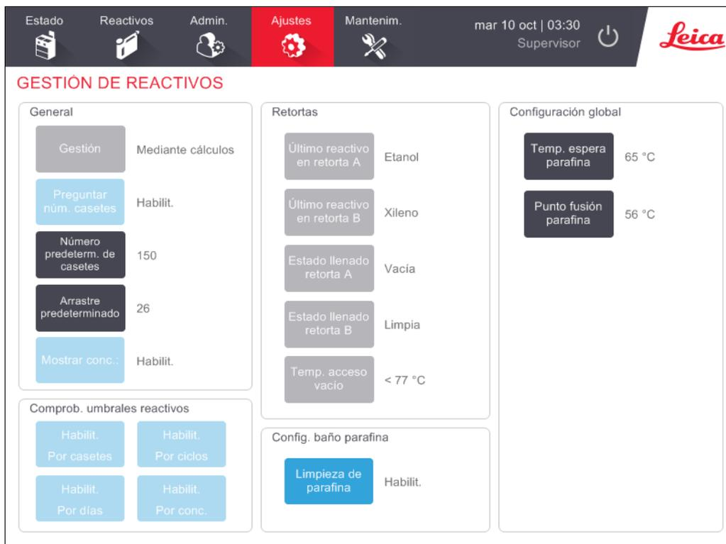
Puede visualizarse, pero no cambiarse, una serie de otros valores de configuración. Póngase en contacto con atención al cliente para cambiar cualquiera de estos parámetros. La pantalla también muestra el estado de cada retorta y el último reactivo de cada retorta.
