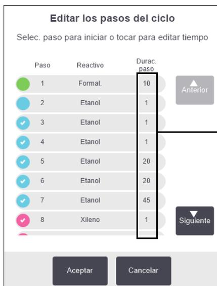
Pulse una duración de paso para abrir el cuadro de diálogo **Duración** y establecer una nueva duración del paso.
