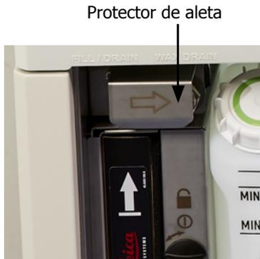
Figura 5.11: Aleta para el llenado/drenaje remoto abierta con el conducto para reactivos (izquierda) y el conducto para el residuo de la parafina (derecha).
