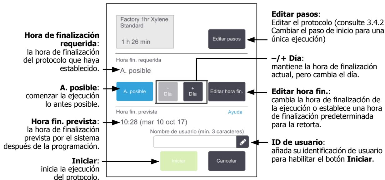
Cada retorta tiene un valor de programación predeterminado. El cuadro de diálogo **Programación** siempre se abre para mostrar la configuración predeterminada de la retorta. Puede aceptar este valor predeterminado o cambiar la configuración para la ejecución: hay opciones para establecer una hora de finalización diferente o ejecutar el protocolo lo antes posible (opción **A. posible**). También puede cambiar los valores predeterminados de las retortas desde el cuadro de diálogo **Programación**.
