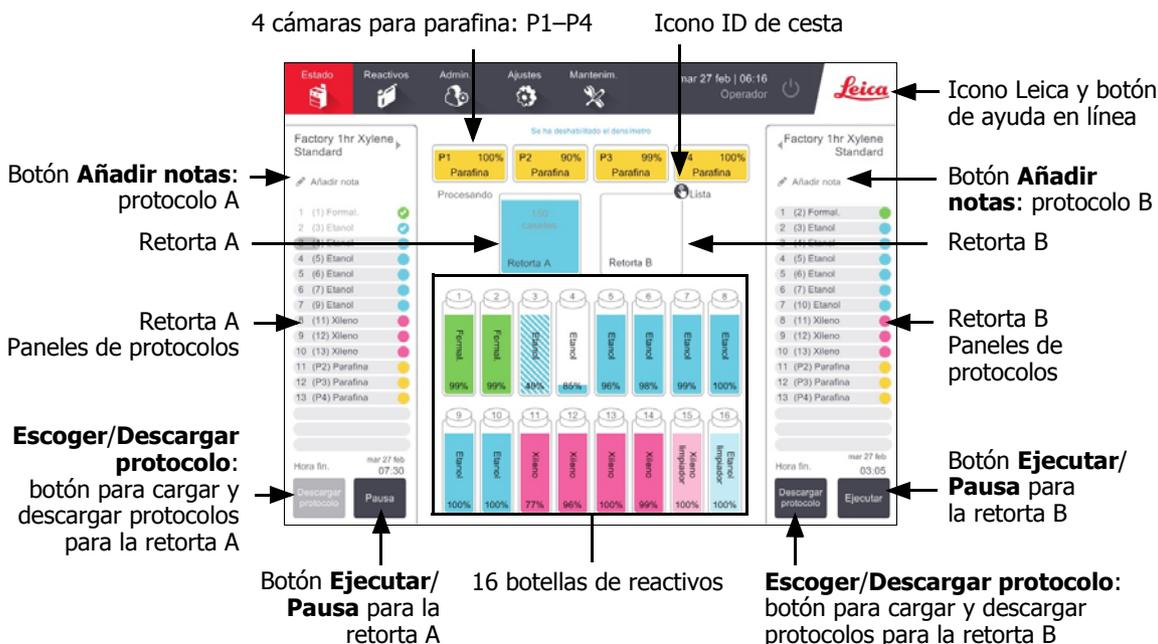
El área central de la pantalla muestra el estado de las estaciones y las retortas. Los paneles de los laterales de la pantalla muestran los protocolos cargados para las retortas. Consulte:
