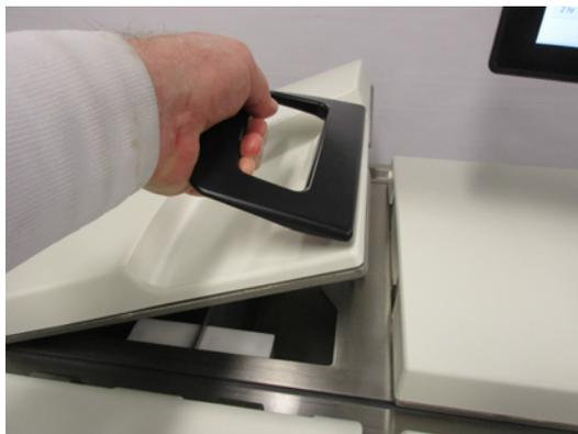
Asegúrese siempre de que la presión del baño de parafina es la presión ambiental antes de abrir las tapas. Si la presión no es la ambiental, descargue la presión del baño primero. Puede hacerlo cuando realice una pausa de un protocolo en ejecución o desde la pantalla **Reactivos > Operaciones manuales**. (Consulte 6.1.1 Operaciones manuales).
