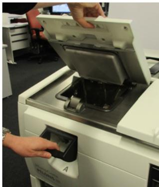
Sea siempre consciente del contenido, de la temperatura y de la presión de una retorta antes de abrirla. En determinados casos, puede que necesite establecer la presión y la temperatura de la retorta manualmente antes de poder abrirla con total seguridad (consulte Descargar la presión de una retorta en la página 32).
