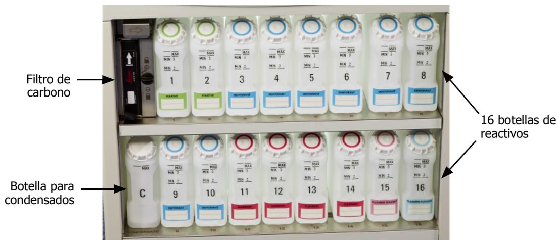
El armario para reactivos alberga las botellas de reactivos, la botella para condensados y el filtro de carbono. Está retroiluminado y las botellas son traslúcidas para que pueda ver fácilmente el nivel de reactivo de una botella. Consulte:
