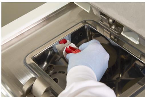
С другой стороны инструмента для очистки датчиков уровня жидкости имеется выступ, который можно вставить в канал для воздуха в парафиновой ванне. Это поможет предотвратить попадание парафина внутрь прибора во время чистки верхней поверхности парафиновых ванн.
