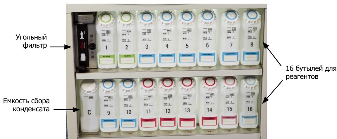
В шкафу для реагентов размещаются бутылки для реагентов, емкость сбора конденсата и угольный фильтр. Шкаф имеет заднюю подсветку, а бутылки прозрачны, что позволяет увидеть уровень реагента в бутылки. См.:
