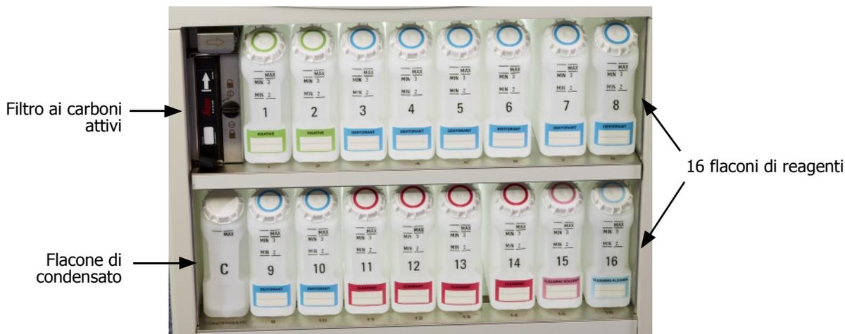
Lo scomparto dei reagenti contiene i flaconi di reagenti, il filtro ai carboni attivi e il flacone di condensato. La retroilluminazione dello scomparto e i flaconi traslucidi consentono di vedere il livello del reagente all'interno di un flacone. Vedere:
