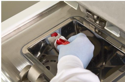
Dall'estremità opposta dello strumento di pulizia degli LLS fuoriesce un'aletta che può essere inserita all'interno dello sfiato dell'aria del bagno di paraffina. In questo modo si evita che la paraffina cada all'interno dello strumento durante la pulizia della superficie superiore dei bagni di paraffina.
