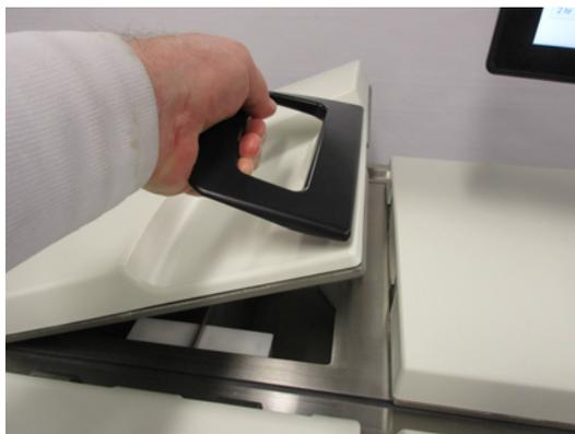
Prima di aprire i coperchi, verificare sempre che la pressione del bagno di paraffina sia a livello ambiente. Se la pressione non è a livello ambiente, effettuare prima lo sfiato del bagno. Questa operazione può essere effettuata quando si interrompe un protocollo in esecuzione oppure dalla schermata **Reagenti > Operazioni manuali**. (Vedere 6.1.1 Operazioni manuali).
