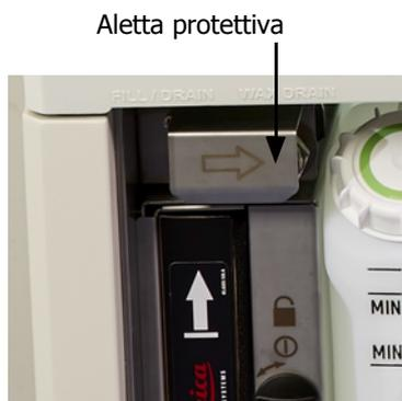
Figura 5.11: Aletta di riempimento/scarico remoto aperta con la linea del reagente (sinistra) e la linea di smaltimento della paraffina (destra).
