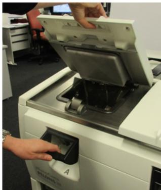
Prima di aprire una storta, verificarne sempre il contenuto, la temperatura e la pressione. In alcuni casi può essere necessario impostare manualmente la pressione e la temperatura della storta prima di poterla aprire in modo sicuro (vedere Sfiato di una storta a pagina 32).
