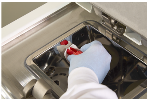
Σχήμα 7.4: Η χρήση του εργαλείου καθαρισμού των LLS
