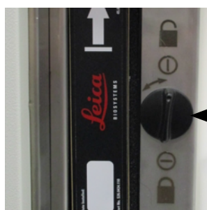
Σχήμα 7.10: Ξεκλείδωμα του φίλτρου
