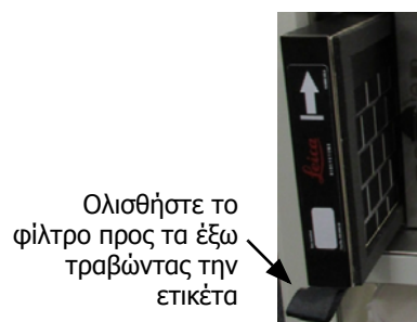
Σχήμα 7.11: Αφαίρεση του φίλτρου
