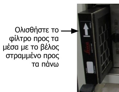
Σχήμα 7.12: Αντικατάσταση του φίλτρου άνθρακα με το βέλος διεύθυνσης (1) προς τα πάνω
