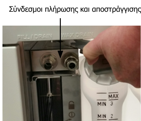
Σχήμα 5.11: Ανοιχτό επικάλυμμα απομακρυσμένης πλήρωσης/αποστράγγισης με τη γραμμή αντιδραστηρίων (αριστερά) και τη γραμμή αποβλήτων παραφίνης (δεξιά).
