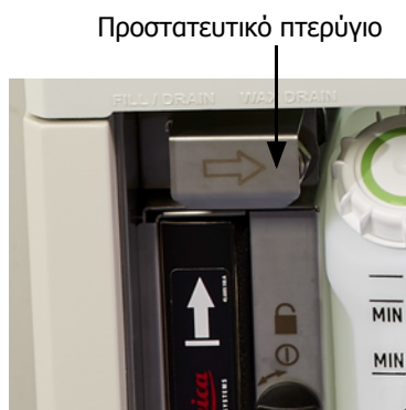
Σχήμα 5.10: Κλειστό επικάλυμμα απομακρυσμένης πλήρωσης/αποστράγγισης
