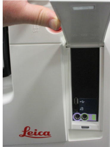
Σχήμα 2.17: Μπροστινή θύρα USB, πίσω από το επικάλυμμα
