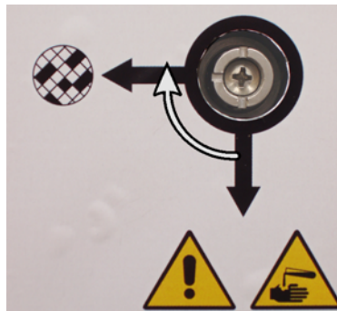
Σχήμα 2.20: Βαλβίδα επιλογής ατμού στην εσωτερική θέση φίλτρου
