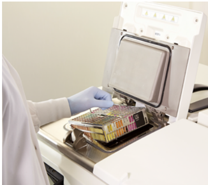
Σχήμα 2.8: Τοποθέτηση ενός καλαθιού σε έναν θάλαμο υποδοχής
