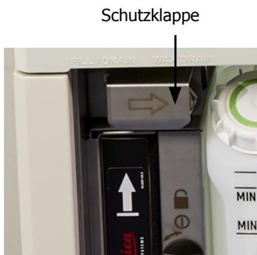
Abbildung 5.11: Geöffnete Schutzklappe mit Reagenzienleitung (links) und Wachsablassleitung (rechts).
