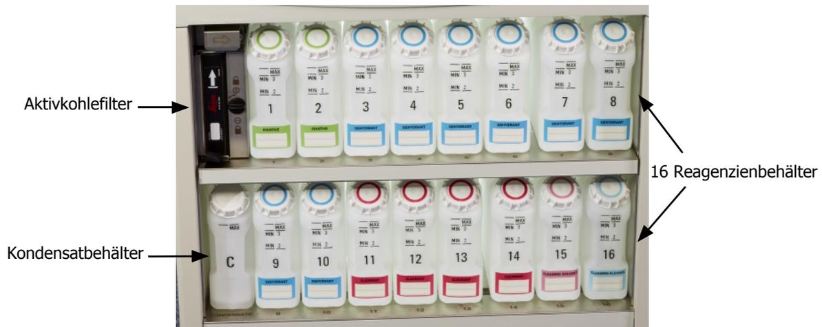
Im Reagenzienfach sind die Reagenzienbehälter, der Kondensatbehälter und der Aktivkohlefilter untergebracht. Es ist hinterleuchtet, und die Behälter sind durchsichtig, um das Erkennen des Reagenzienfüllstands in einem Behälter zu erleichtern. Siehe:
