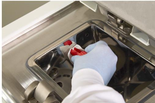
Aus dem anderen Ende des Reinigungswerkzeugs für Füllstandssensoren ragt ein Flansch heraus, der in die Entlüftung des Wachsbad eingeführt werden kann. Dadurch wird verhindert, dass Wachs in das Gerät fällt, wenn Sie um die Oberfläche des Wachsbad herum reinigen.
