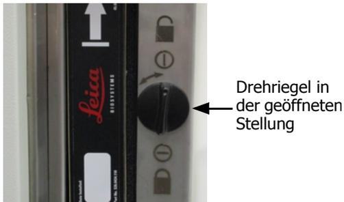
Abbildung 7.11: Entnehmen des Filters
