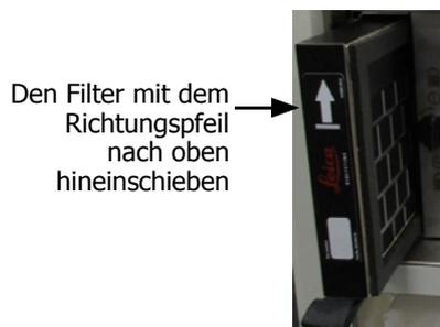
Abbildung 7.13: Verriegeln des Filters
