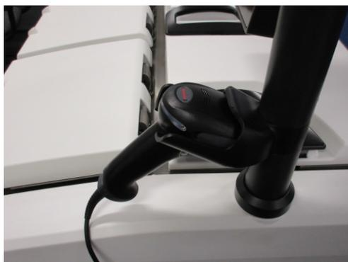
Le scanner peut être utilisé pour saisir rapidement votre ID utilisateur, l'ID sur une étiquette anti-reflet d'un panier (décrite page 35), et le lot ou un numéro de lot d'un réactif. L'appareil peut scanner les formats de codes-barres suivants :
