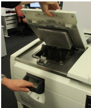
Avant d'ouvrir une étuve, pensez toujours à ce qu'elle contient, sa température et sa pression. Dans certains cas, vous devrez régler manuellement la pression et la température de la étuve avant de l'ouvrir en toute sécurité (voir Ventilation d'une étuve à page 31).
