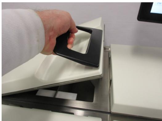
Vérifiez toujours que la pression du bain de paraffine est à pression ambiante avant d'ouvrir les couvercles. Si la pression n'est pas ambiante, ventilez d'abord le bain. Vous pouvez effectuer cette opération lorsque vous mettez un protocole d'exécution en pause ou à partir de l'écran **Réactifs > Opérations manuelles**. (Voir 6.1.1 Opérations manuelles.)
