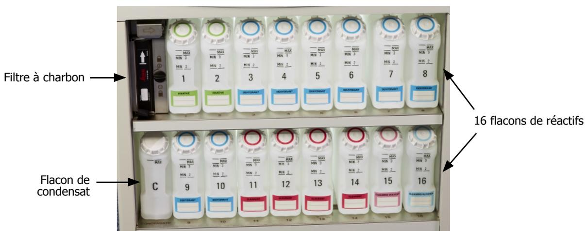
L'armoire à réactifs contient les flacons de réactif, le filtre à charbon et le flacon de condensat. Elle est rétro-éclairée et les flacons sont translucides afin de vous aider à voir le niveau de réactif dans un flacon. Voir :
