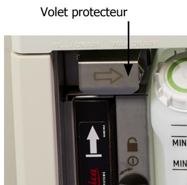
Figure 5.11 : Volet de remplir/purger en externe ouvert avec conduite de réactifs (gauche) et conduite d'évacuation de la paraffine (droite).
