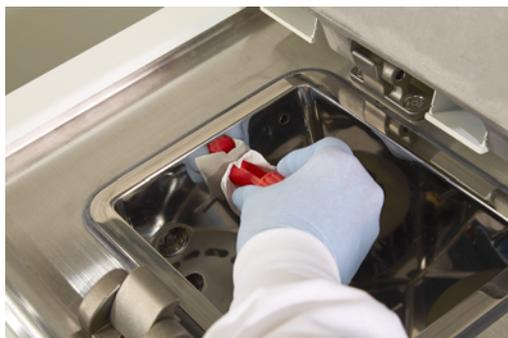
À l'autre extrémité de l'outil de nettoyage pour CNL se trouve une cosse pouvant être insérée dans l'évent d'aération du bain de paraffine. Cela empêchera la paraffine de tomber dans l'appareil lorsque vous nettoyez le pourtour de la surface supérieure des bains de paraffine.
