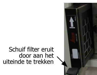
Figuur 7.11: De filter verwijderen
