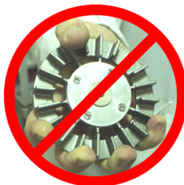
Figuur 7.9: Hanteren van de roerder—correct (links) en incorrect (rechts)
