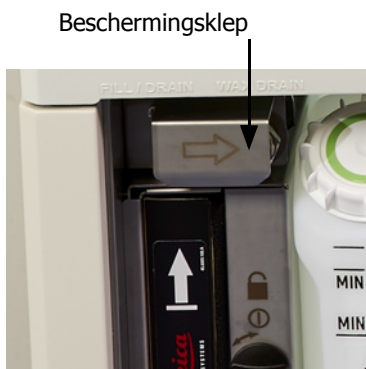
Figuur 5.10: Afvoerklep extern legen/vullen gesloten
