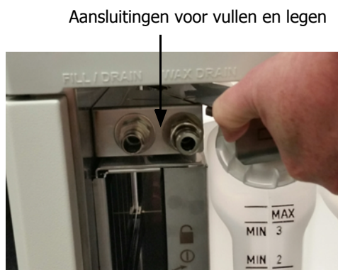
Figuur 5.11: Afvoerklep extern vullen/leggen open naar reagensleiding (links) en waxafvalleiding (rechts).
