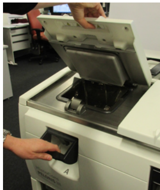
Figuur 2.3: Een retortdeksel openen
