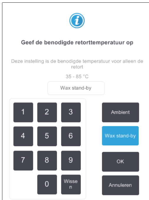
Figuur 6.2: Instellen van de retorttemperatuur op de wax stand-by temperatuur
