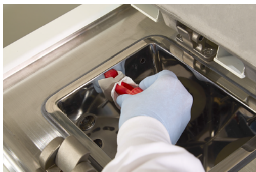
Figuur 7.4: Het LLS-schoonmaakhulpmiddel gebruiken
