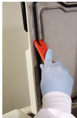
Figuur 7.3: De waxschrapper gebruiken
