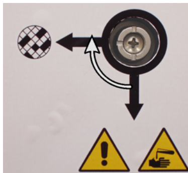
Figuur 2.20: Dampkeuzeklep in positie voor intern filteren
