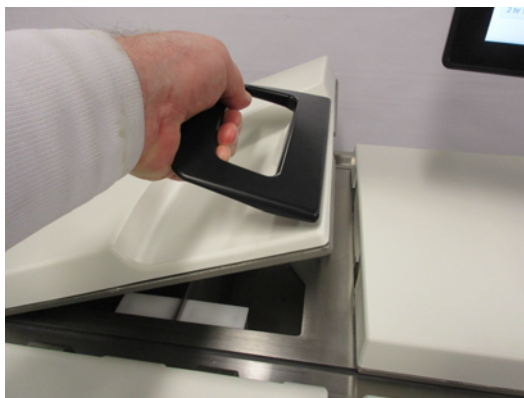
Figuur 2.13: Openen van een waxbaddeksel
