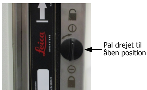
Figur 7.10: Oplåsning af filteret
