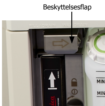
Figur 5.10: Klappen for ekstern fyld/tøm lukket
