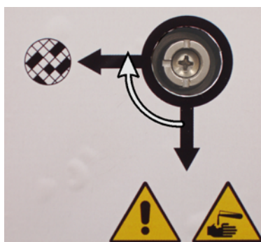
Figur 2.20: Dampventilvælgeren i stillingen internt filter
