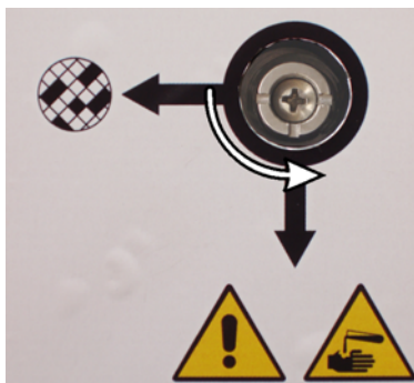
Figur 2.19: Dampvælgerventilen i stillingen eksternt system
