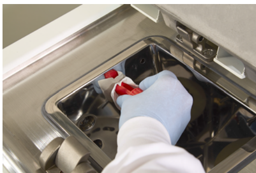
Figur 7.4: Brug af LLS-rengøringsværktøjet
