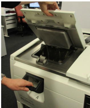
Figur 2.3: Åbning af en retortlåge
