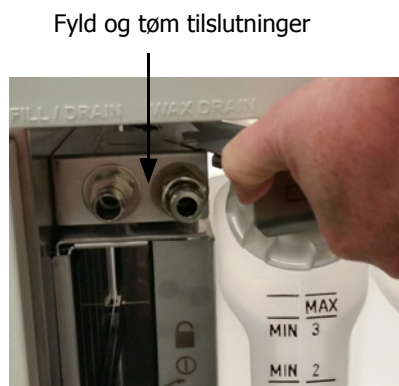
Figur 5.11: Klappen for ekstern-fyldning/tømning åben med reagenslinjen (til venstre) og voksaftapningslinjen (til højre).
