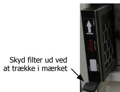
Figur 7.11: Fjernelse af filteret
