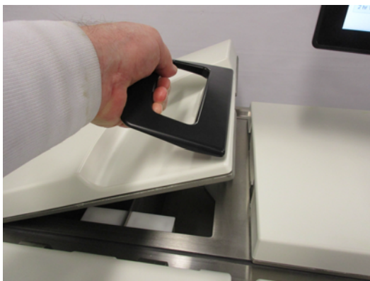
Figur 2.13: Åbning af låget til et voksbad
