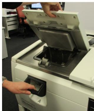
開啟蒸餾瓶蓋子前，一定要清楚蒸餾瓶的內容物、溫度及壓力。有時，在安全開啟前可能需要手動設定蒸餾瓶的壓力和溫度（請參閱第 31 頁的「讓蒸餾瓶排氣」）。
