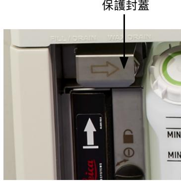
圖 5.11：遠端填充 / 排放封蓋開啟，附帶試劑管線（左）與蠟廢棄物管線（右）。
