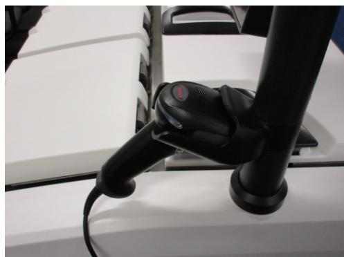
您可使用掃描器快速輸入您的使用者 ID、籃子上抗反射標籤上的 ID（如第 35 頁所述），以及試劑的批號。掃描器可掃描以下條碼格式：
