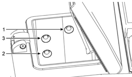
每個蒸餾瓶都有三個液位感應器用來監測液位。下方的兩個感應器監測兩籃及三籃液位。如果進入蒸餾瓶的液體超出最大容量 (5.3 公升)，就會觸發頂部感應器。頂部感應器可提供安全功能。
