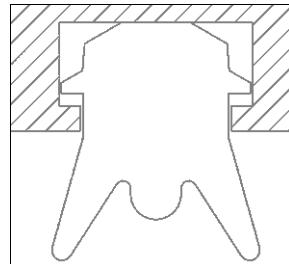
4. 用手指按壓封條一圈，平衡每個封條的張力。此舉應消除任何過緊或過鬆的部分。
