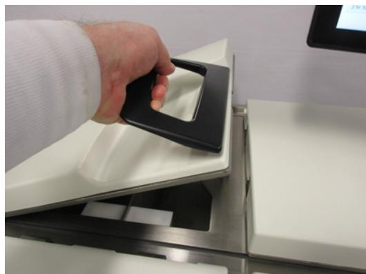
開啟蓋子前，請務必確保蠼槽壓力等於環境壓力。若與環境壓力不同，首先要讓蠼槽排氣。此時，您可以暫停執行處理方案，或在「試劑」>「手動操作」畫面操作。（請參閱「6.1.1 手動操作」。）
