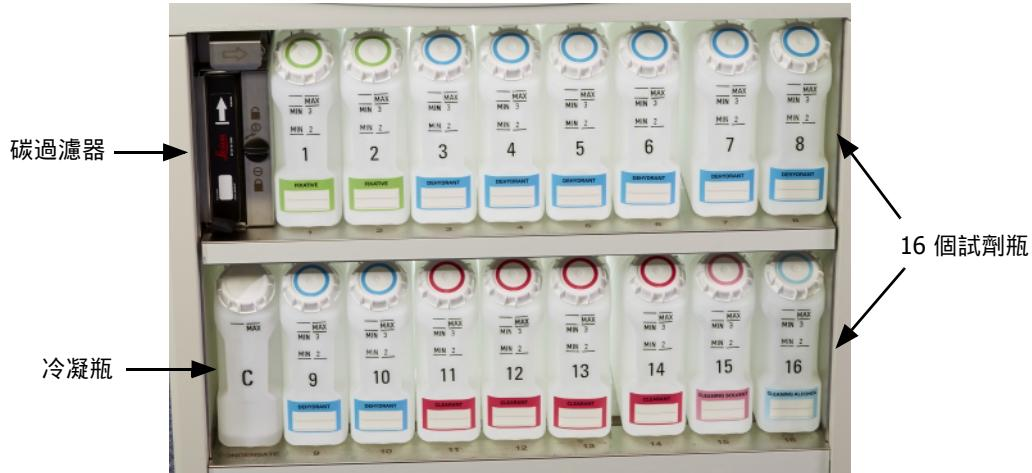
試劑櫃內有試劑瓶、冷凝瓶及碳過濾器。試劑櫃具有背光，瓶子為透明材質，可讓您查看瓶內試劑的液位。請參閱：
