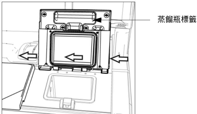
刮除蒸餾瓶邊緣及儀器頂部蠟槽周圍（蓋子放置處）的蠟。確保蓋子在關閉時完全密封。
