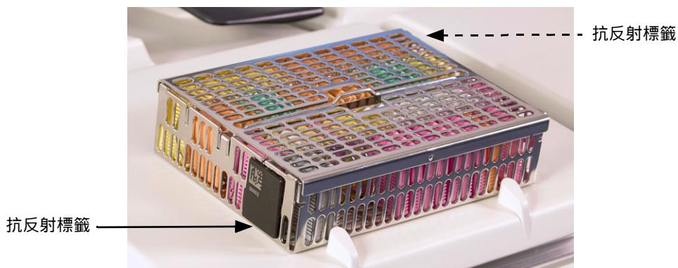
每個籃子一個抗反射標籤，上面印有一個獨特的條碼。籃子放入蒸餾瓶之前可以掃描條碼。此識別代碼會與執行處理方案時的其他詳細資訊一起記錄。掃描抗反射標籤後，您可以按任一方向將籃子放入蒸餾瓶內（即左側或右側放置印有條碼的反射標籤）。
