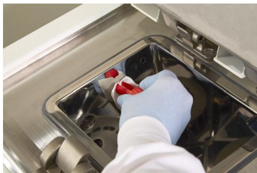
LLS 清潔工具另一端突出的凸耳可插入蠟槽排氣口，有助於在清潔蠟槽頂部表面周圍時防止蠟落入儀器。
