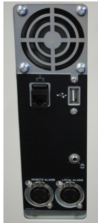
图 2.16: 后面板上的 USB 端口
