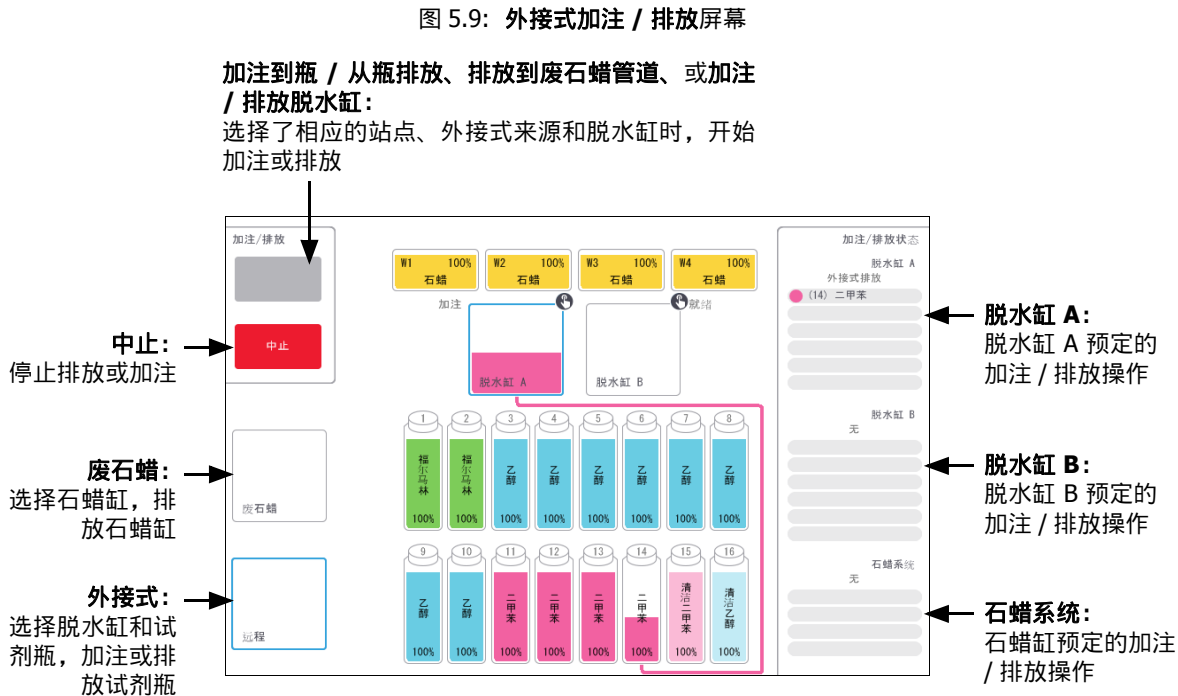
图 5.9 显示外接式加注 / 排放屏幕及介绍的主要功能：
