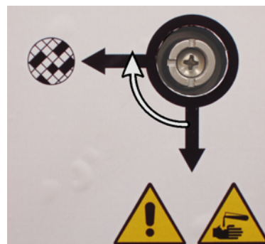
图 2.20: 内置滤网位置的蒸汽选择阀
