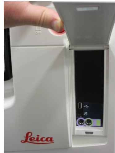
图 2.17: 正面 USB 端口，位于滑盖下方
