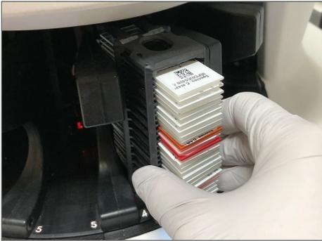
Rack inserido totalmente na abertura do rack:
