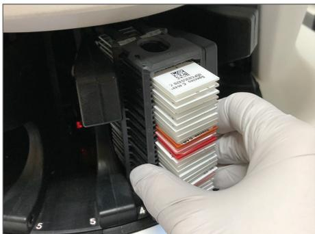
ラックがラックスロットに完全に挿入されている:
