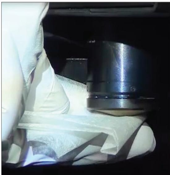
7. きれいなリントフリーのマイクロファイバー布を使って、ステップ6に記述されたのと同じ方法でケーラーを清掃します。下図に白色の円で示されるように、ケーラーは対物レンズの下方にあります。
