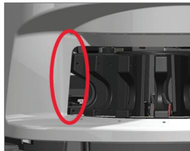
2. ラックローディングエリア内のラックが正しく挿入されていることを確認します:
