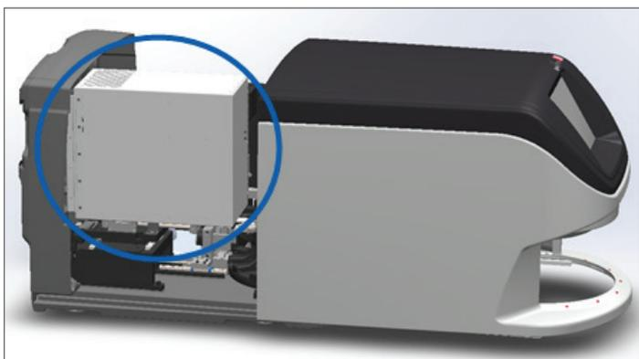
2. VPUラッチを手前に180度回転させて、VPUを所定位置に固定します。
