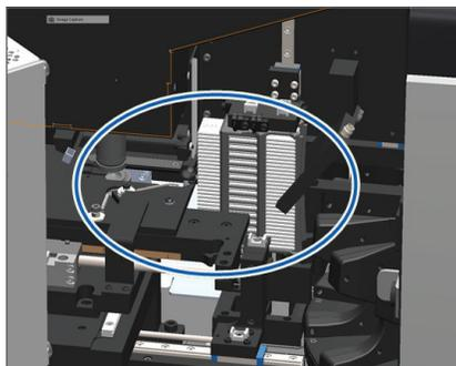
6. Se possível, remova cuidadosamente a lâmina que está causando a obstrução.
