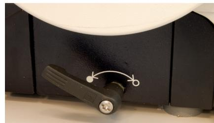
El freno del volante del RM2235 se muestra aquí en su posición de bloqueo. El freno puede activarse con el volante en cualquier posición. Ni el bloqueo del volante ni el freno del volante se pueden utilizar para inmovilizar el microtomo.
