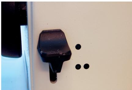
El dispositivo de recorte mecánico debería ser utilizado con cuidado al realizar el desbastado, particularmente el ajuste bajo (..) que produce un avance de 30  $\mu\text{m}$  cuando está activado.
