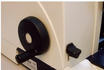
Al realizar el desbastado es preciso utilizar la rueda de avance de desbaste con cuidado para evitar cortar trozos gruesos de la superficie de la muestra involuntariamente y ocasionar daños.
