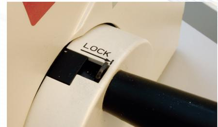
El bloqueo del volante se muestra aquí con el volante en la posición de las 12 del reloj y el bloqueo activado. Dicho bloqueo sólo se activará en esta posición en la parte superior de la carrera de corte.
