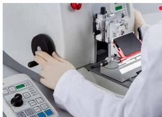
Todo microtomista pode usar o modo de seccionamento de sua preferência: Automatizado, semiautomatizado e manual.
