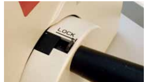
Hier ist die Handradverriegelung dargestellt; das Handrad befindet sich in der 12 Uhr-Stellung und ist in dieser Stellung verriegelt. Die Verriegelung kann nur in dieser Stellung in der oberen Endlage des Schneidehubs aktiviert werden.
