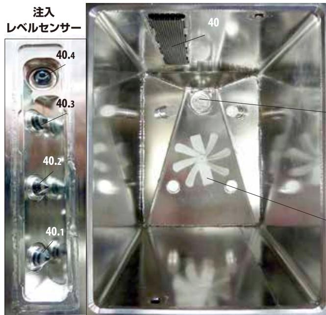
ストレイナー (42) をレトルトのフロアの排出開放部に挿入します。
