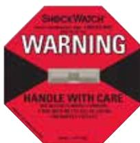
「ショックウォッチ」は、規定値を超える衝撃が加わると、赤色に変わり、そのことを示す精密ガラス製チューブシステムです。所定の加速度(G値)を超える衝撃を受けると、チューブ内の液体の表面張力が破壊されます。これにより、インジケーターチューブの色が変化します。
