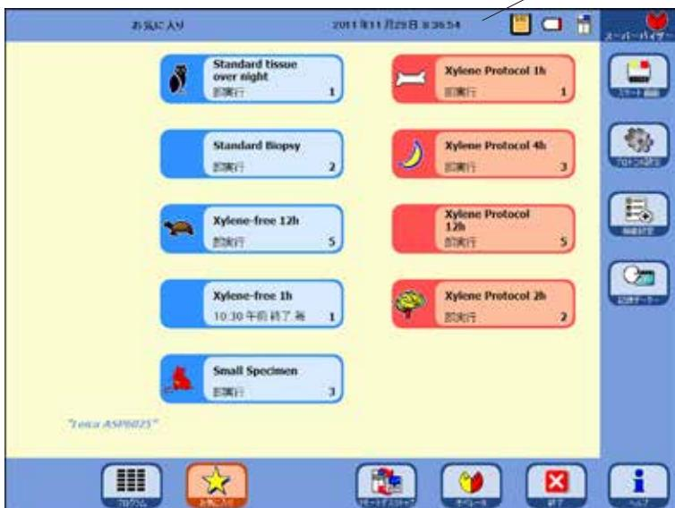
ASP6025はカラーLCDタッチスクリーンから操作します。
