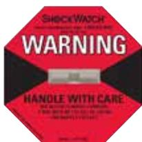
V systému Shockwatch znázorňuje přesná skleněná trubička červeným zabarvením nárazy nebo rázy nad specifikovanou úrovní intenzity. Překročením definovaného zrychlení (hodnoty g) se poruší povrchové napětí kapaliny uvnitř trubičky. To způsobí změnu barvy indikační trubičky.
