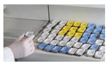
La placa fría soporta hasta 65 casetes en su gran superficie de trabajo. La eficiencia de refrigeración es importante. Por eso, la placa fría está equipada con un módulo de control que se adapta al ambiente para garantizar que la temperatura de funcionamiento se estabilice a -6 °C, adaptándose a los entornos de laboratorio estándar.
