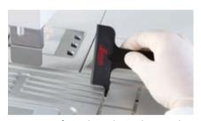
Una superficie de trabajo de metal fácil de limpiar ayuda a reducir la adherencia de sustancias. El diseño robusto de la herramienta especial de limpieza de parafina ayuda a limpiar las hendiduras.
