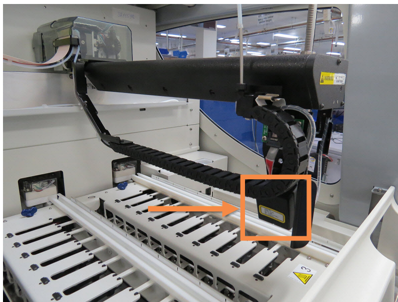
Abbildung 2-6: Abbildung des Hauptroboters mit dem durch einen Pfeil gekennzeichneten ID-Imager
