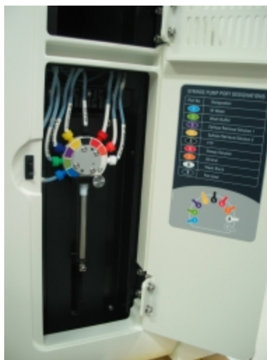
Abbildung 2-5: Spritze hinter der Klappe
