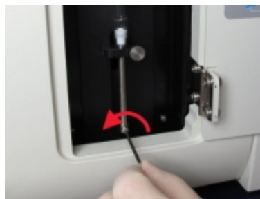
Abbildung 12-17: Lösen der Feststellschraube des Kolbens mit einem Sechskantschlüssel
