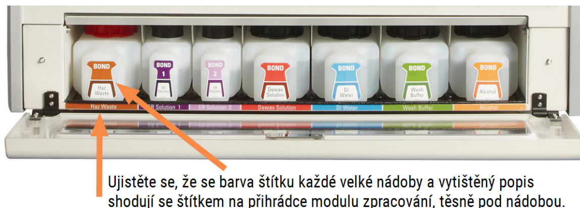
Obrázek 2-16: Správné umístění reagensů ve velkých nádobách BOND-MAX
