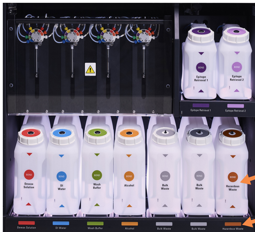
Obrázek 2-14: Správné umístění velkých nádob na reagentie BOND-III
