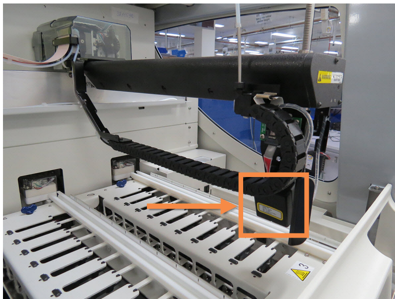
Obrázek 2-6: Fotografie hlavního robotu se snímačem ID (oblast označená šipkou)
