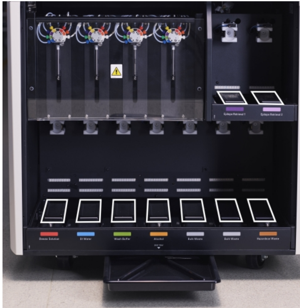
Obrázek 12-13: Odkapávací vany velkých nádob BOND-III zobrazující kryty snímačů hmotnosti
