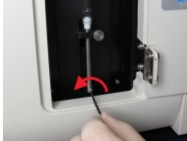
Obrázek 12-17: Odšroubujte zajišťovací šroub pístu šestihranným klíčem.
