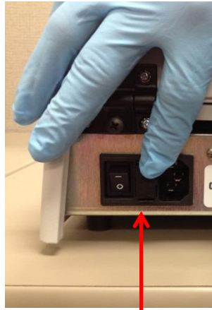
Tiroir à fusibles
