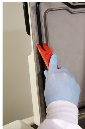
Figura 7-3: Utilização do raspador de parafina
