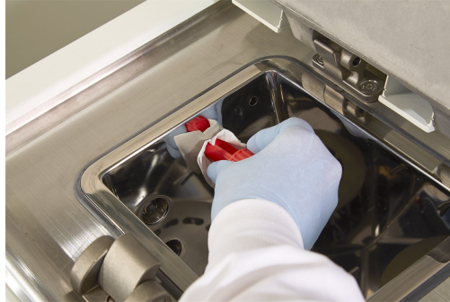
Figura 7-4: Utilização da ferramenta de limpeza do LLS
