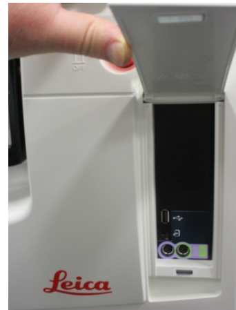
Figura 2-19: Porta USB dianteira, por baixo da aba
