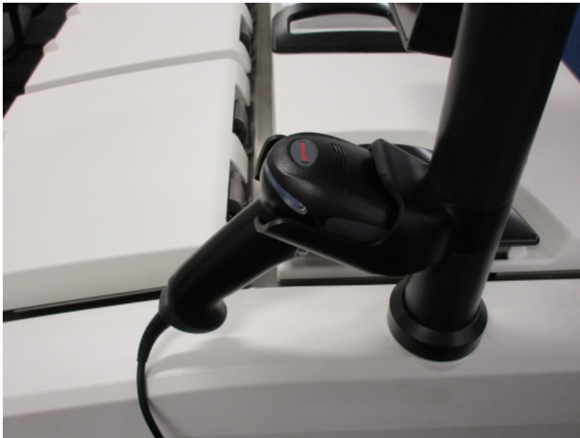
Figura 2-15: Leitor de códigos de barras no respetivo suporte
