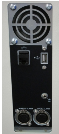
Figura 2-18: USB no painel posterior
