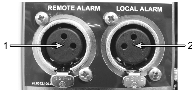
Figura 2-23: Conectores do alarme remoto (1) e do alarme local (2)
