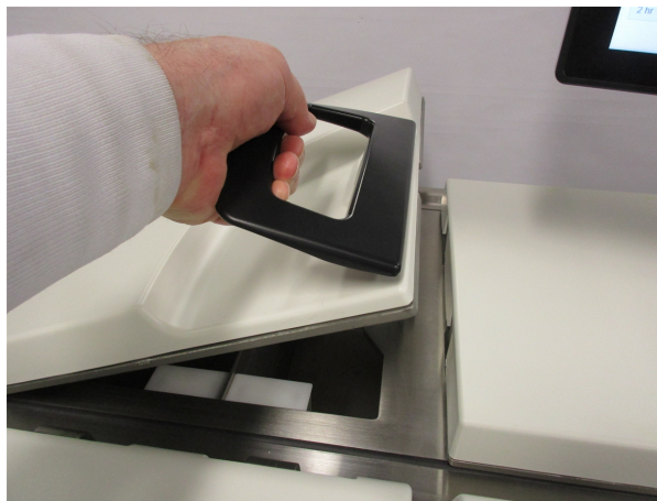
Figura 2-13: Abrir uma tampa do banho de parafina
