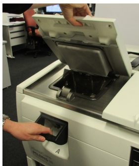
Figure 2-3: Ouverture du couvercle de la chambre de réaction
