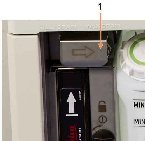
Figure 5-11: Volet de remplir/purger en externe ouvert avec conduite de réactifs (gauche) et conduite d'évacuation de la paraffine (droite).
