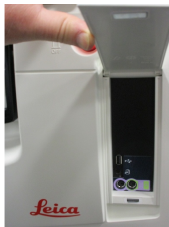
Figure 2-19: Port USB avant, derrière un rabat
