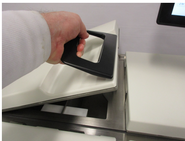
Figure 2-13: Ouvrir le couvercle d'un bain de paraffine
