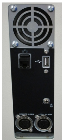
Figure 2-18: USB sur le panneau arrière
